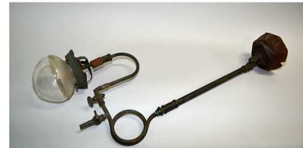
58)両用ガスランプ 年代:明治時代 天井に固定設置して利用するガス灯で、また管の途中で分岐をして熱用のガス器具を利用できるようになっています。
